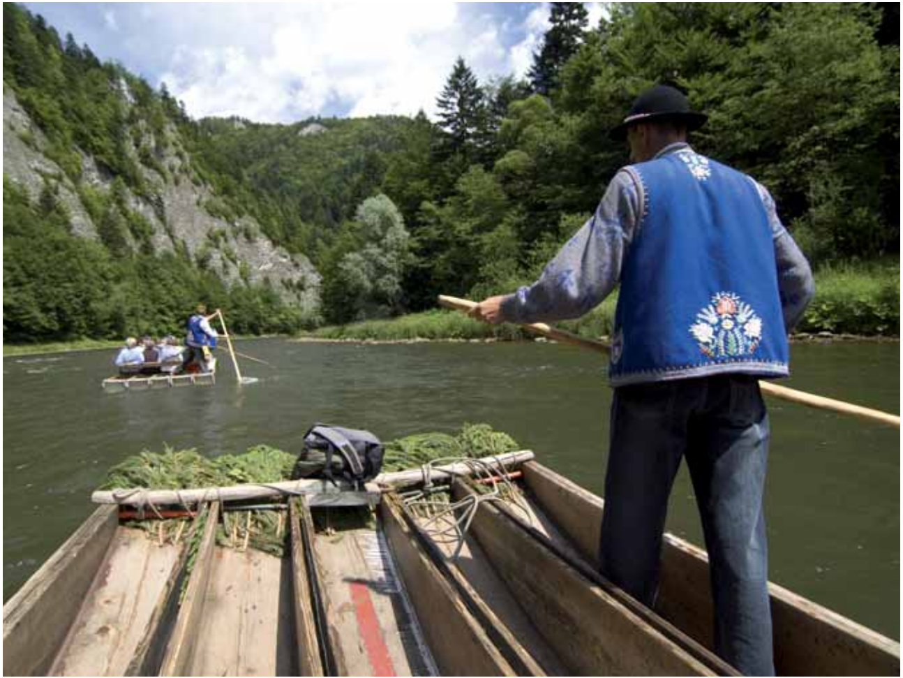
Splyw Dunajcem przez Przełom Pieniński. Tratwę składającą się z 5 członów spiętych poprzeczną spinką prowadzi dwóch flisaków, używając długich żerdzi zwanych spryszkami. Fot. Renata i Marek Kosiński
