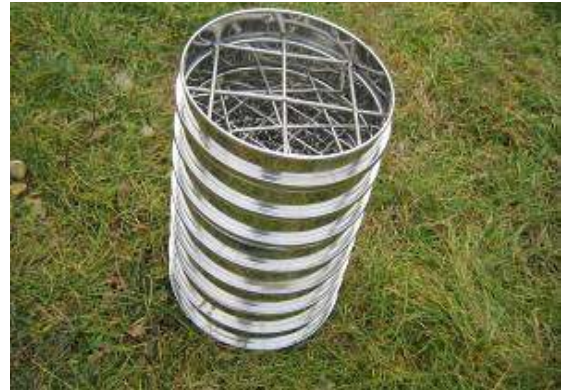
Fot. 27. Zestaw sit do przesiewania żwiru firmy Retsch (fot. J. Ponicka).
