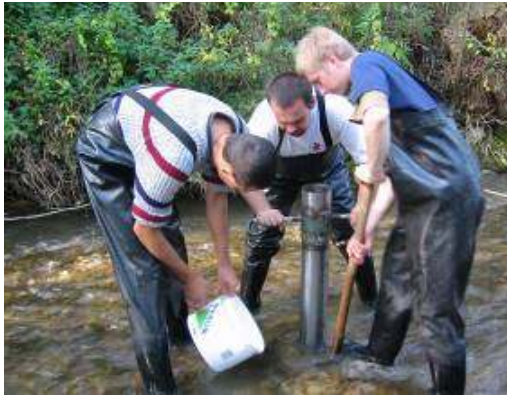
Fot. 26. Pobieranie próby żwiru przy pomocy sondy własnej konstrukcji. Hoczewka, październik 2005. (fot. M. Duc).
