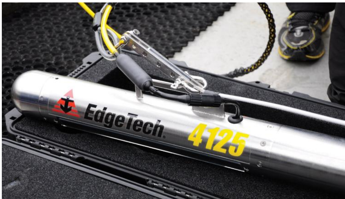
Sonar boczny EdgeTech 4125, którym identyfikowano narzędzia połowowe. Fot. W. Górski
