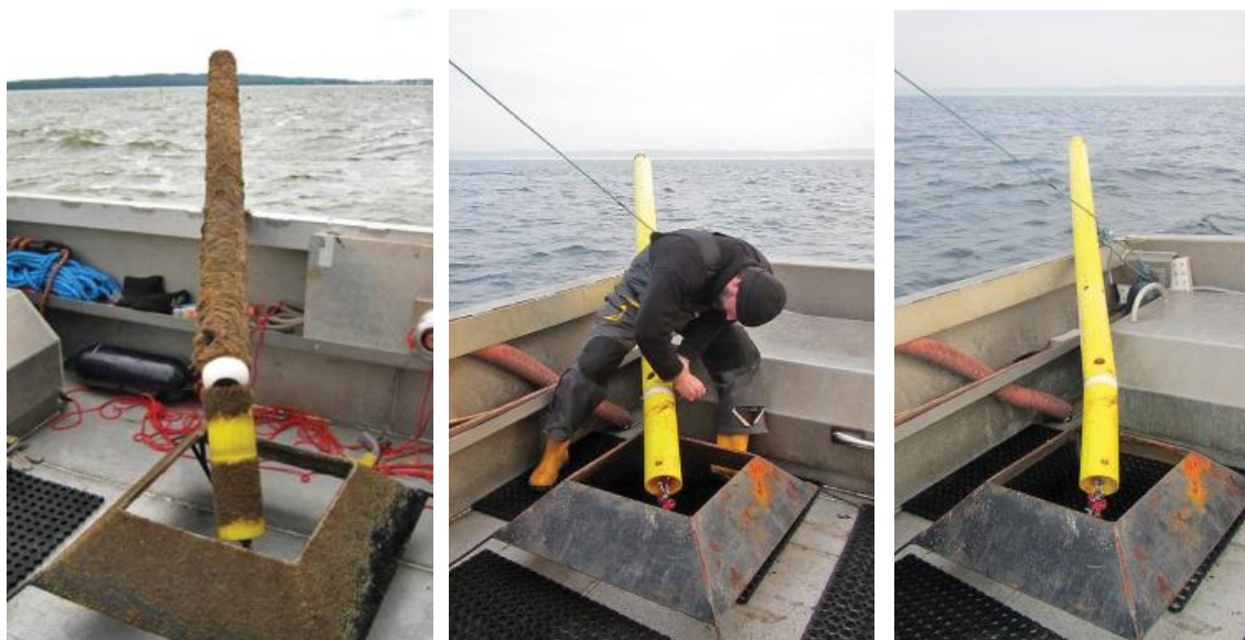
Serwis i przygotowanie do wystawienia kotwicy wraz z detektorem hydroakustycznym. Fot. B. Arciszewski
