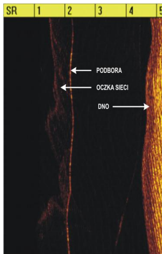
Obraz z sonaru bocznego przedstawiający sieć skrzelową z widocznymi oczkami sieci i linką dolną (podborą)
