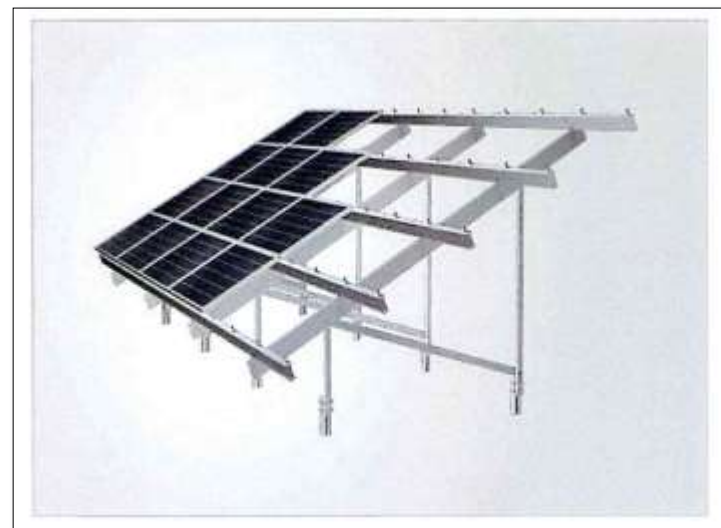
Widok stołu montażowego
