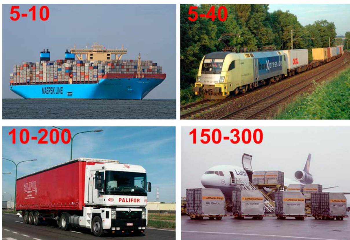
RYSunEK 7.6. Długodystansowy przewóz towarów: statek, pociąg, ciężarówka, samolot. Zużycie energii w kWh na 100 tonokilometrów. 30
