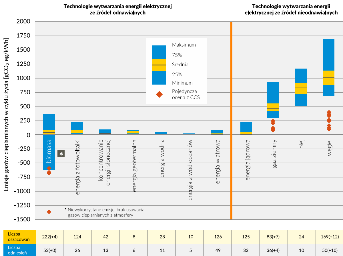
RYСУNEK 9.9. Szacowane emisje gazów cieplarnianych w cyklu życia (g CO 2 eq/kWh) różnych technologii wytwarzających energię elektryczną, łącznie z niektórymi stosującymi CCS 30 .
