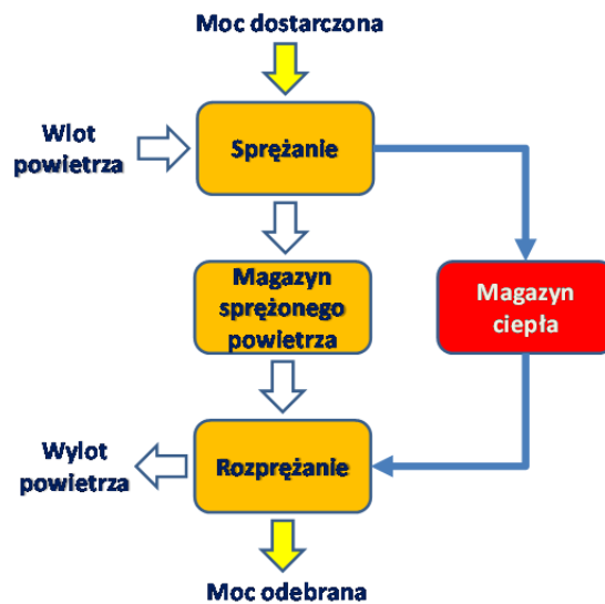
Rys. 9. Zasada działania elektrowni A-CAES – opracowanie własne
