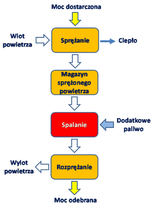
Rys. 10. Zasada działania elektrowni D-CAES – opracowanie własne
